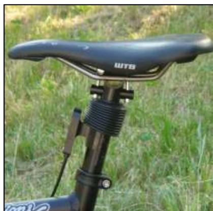
François et Jérôme, en enduristes convaincus, ont équipé leur vélo de tiges de selle ajustables, type Gravity Dropper, Crank Brothers Joplin ou Maverick. Augmenter ou réduire à volonté sa hauteur de selle avec une commande sur le cintre, sans déclipser et de façon très alerte lorsque l'obstacle survient est un vrai avantage sur le terrain très cassant et exigeant en relance de la Transvésubienne.
